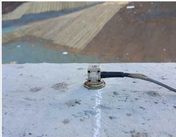
가속도계 설치 현황
